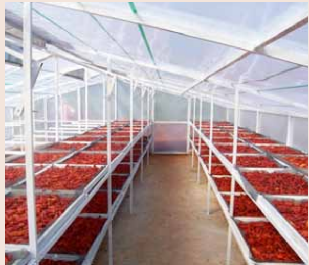
Secadero solar directo tipo invernadero cargado con pimentón.
