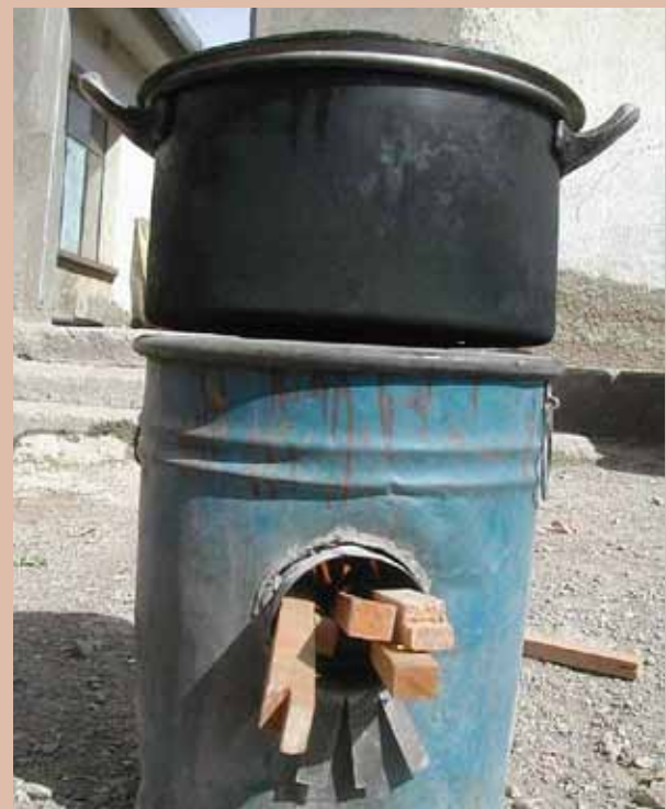
“Rocket Stove” utilizando un barril. Bolivia. 17
