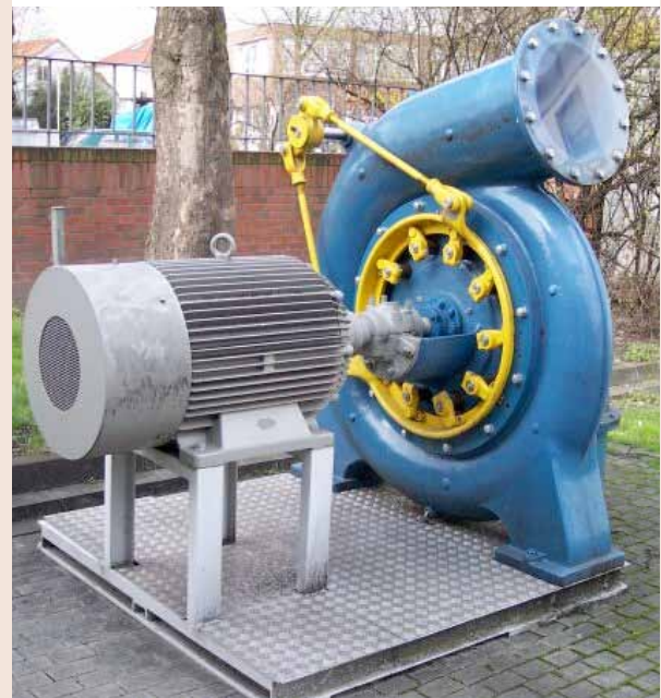
Turbina tipo Francis con generador de electricidad y funcionamiento de la turbina. 38,39
