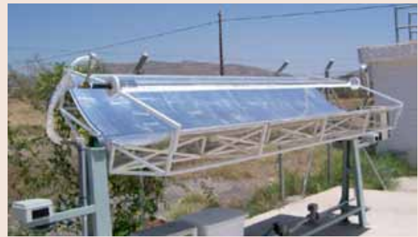
Colectores tubulares con canal parabólico
