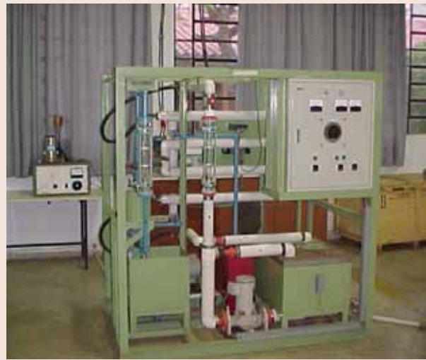
Estación de transferencia de calor.
