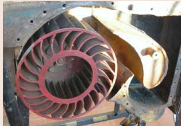
Microturbina hidráulica construida en Misiones, Argentina.
